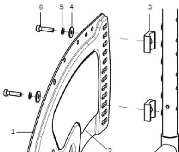
Verschraubung hinten bei Rücken winkelverstellbar
