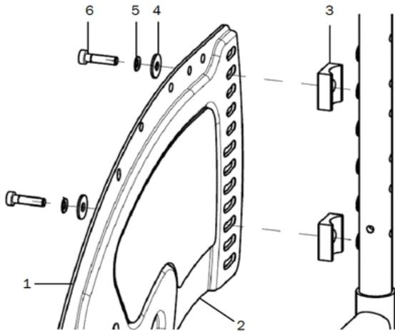
Verschraubung hinten bei Rücken winkelverstellbar
