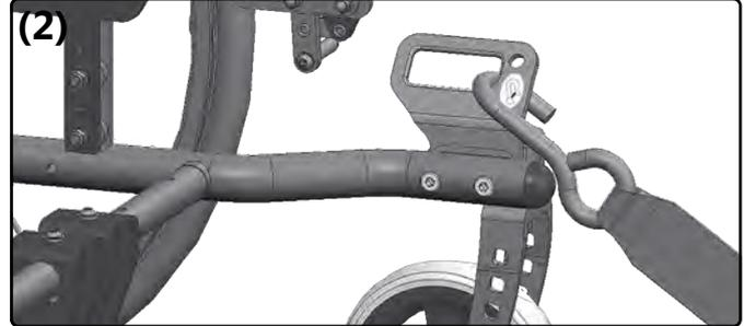
⚠ Die Befestigung des Sitzschalen-Untergestells muss mit einem fahrzeugverankerten 4-Punkt Rollstuhl-Rückhaltesystem nach ISO 10542 erfolgen. Hierbei kann es sich um Karabinerhaken, S-förmige Haken oder um Steckverschlüsse handeln. Das Rollstuhl-Rückhaltesystem muss gemäß der Gebrauchsanweisung des Herstellers sicher befestigt und verwendet werden. **(3A+B)**
